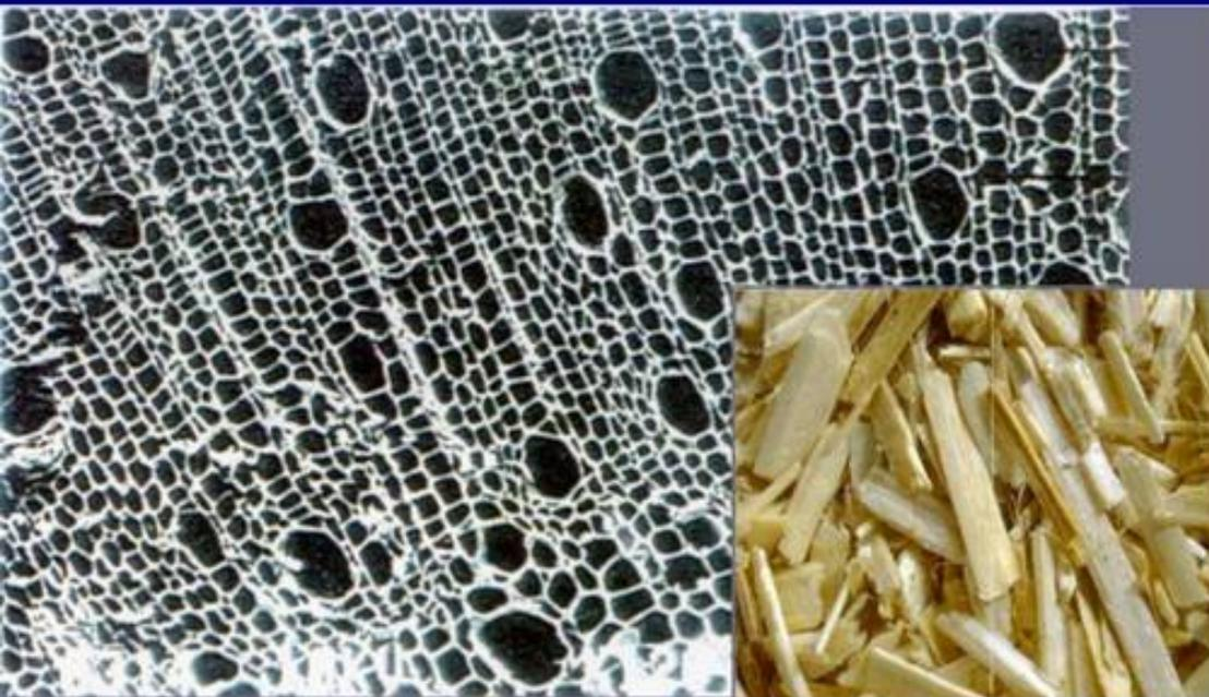
Les isolants végétaux stockent l'humidité de condensation **DANS** leurs fibres, et non entre elles, ce qui ne réduit pas leurs capacités d'isolation et ne nuit pas à leur durabilité
