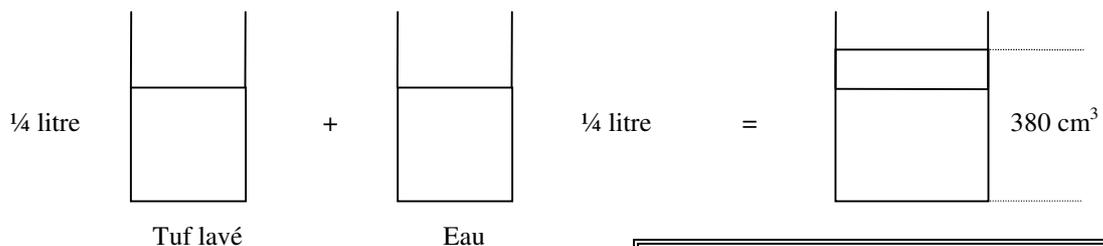
→ Volume apparent du tuf :  $380 - 250 = 130 \text{ cm}^3$
