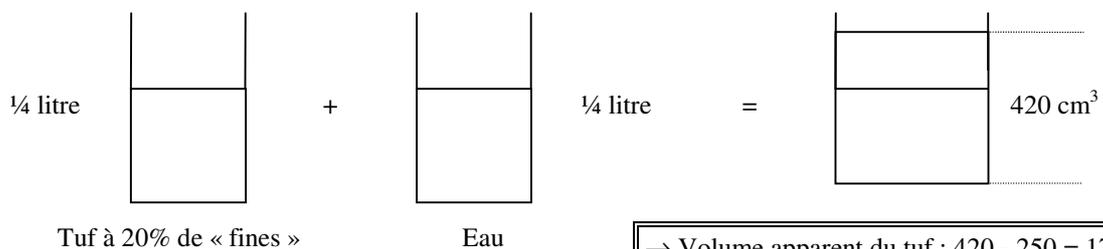
→ Volume apparent du tuf :  $420 - 250 = 170 \text{ cm}^3$
